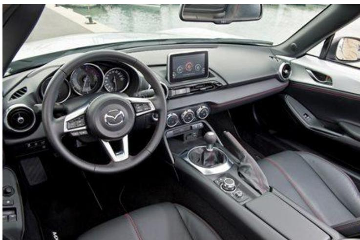
Komplett neu gestaltet wurde die elegante analoge Instrumenteneinheit mit drei chromumrandeten Rundinstrumenten: ein großer Drehzahlmesser im Zentrum, rechts davon der Tacho und links ein Informations-Display mit Tank- und Reichweitenanzeige sowie einer Anzeige für die Kühlwassertemperatur, die im Vergleich zum Vorgänger einen größeren Bereich abdeckt. Die Symmetrie setzt sich über die flügelartige Armaturentafel fort, die auf der Beifahrerseite
