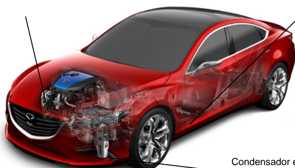
Alternador de tensión variable 12-25 V
