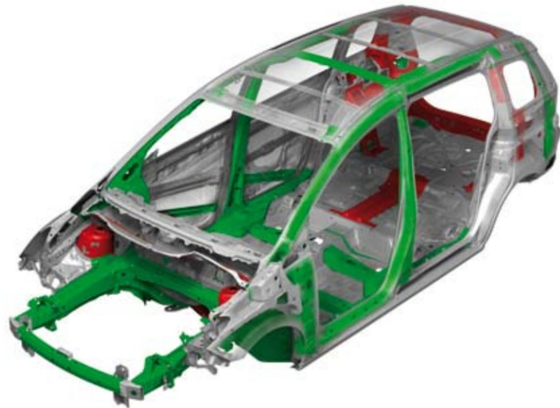
El nuevo Mazda5 resulta más seguro en caso de alcance trasero; la nueva carrocería absorbe de manera eficiente la energía y protege el depósito de gasolina. La estructura que lo rodea está construida con dos placas de acero de alta resistencia de distinto espesor. Los largueros del bastidor son más rectos y se ha optimizado su sección.
